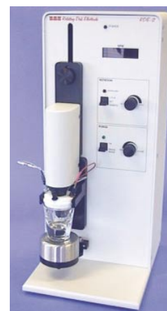
RDE-2, Rotating Disk Electrode
